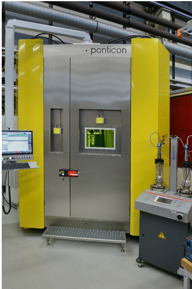
Bild 2: Außenansicht der pE3d- Tripodanlage der Ponticon GmbH im EHLA-3D-Labor des Fraunhofer ILT. © Fraunhofer ILT, Aachen.
